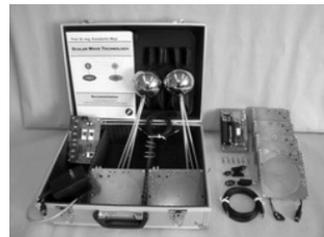
그림 1. 메일 교수가 제작한 무선 전력 전송 실험 키트
